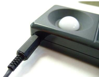
**[注意]**照度計 CANA-0010-ABS3 のアナログ出力電圧範囲は 0-19999Lx レンジで 0-2V 出力となります。ABSⅢの照度入力範囲は 0-2V で、照度計 CANA-0010-ABS3 を接続時は全測定範囲が測定可能となります。
