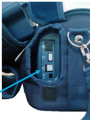
⑤コネクタカバーを開けて、OP用センサー、各種インタフェースコネクタ、ACアダプターを接続します。
