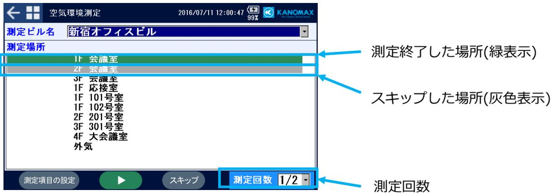
(2)測定するビルの測定項目を設定していない場合は、「測定項目の設定」ボタンをタップして測定項目を設定します。
