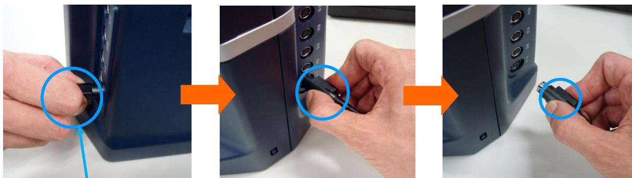
この部分を持ち、手前方向に引っ張りロックを解除しながら、更に手前方向に抜き取ります。
