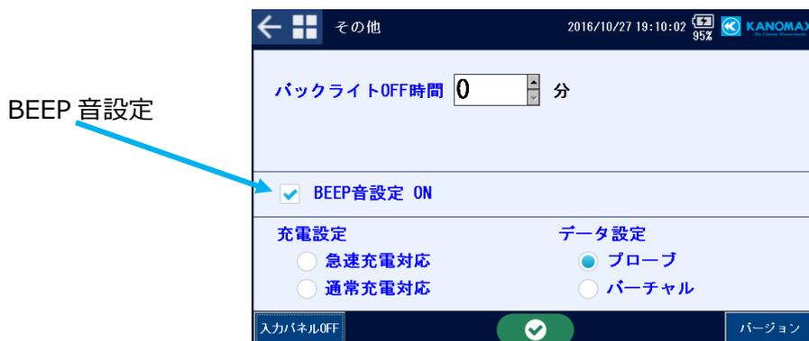
充電設定では使用する AC アダプターにより「急速充電」か「通常充電」かの設定をします。この充電設定は必ず標準付属の AC アダプターを接続して行ってください。AC アダプター未接続の場合は充電設定の選択ができません。ご注意ください。
