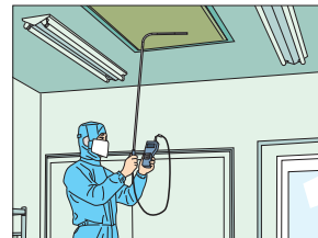
クリーンルーム内の風速測定
