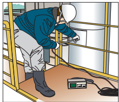
焼却炉の煙道排ガス測定
