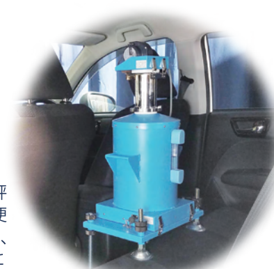
デミスト性能試験用蒸気発生器
