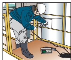
焼却炉の煙道排ガス測定
