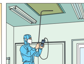
クリーンルーム内の風速測定
