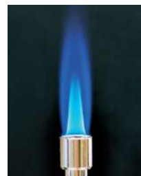
軸対象ブンゼン火炎の温度計測
