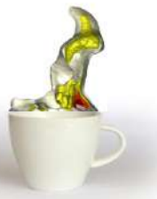
トモグラフィックBOSによる3次元温度分布の可視化例
