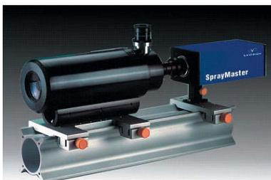
長いワーキングディスタンスで高倍率、高解像度のイメージングが可能な、マクストフ・カセグレン式の光学系です。非常に明るく分解能の高いレンズ系を採用し、PIV用の高解像度CCDカメラと組合せることで、より空間分解能の高い計測に威力を発揮します。
