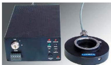
カメラとカメラレンズの間に装着する外部シャッターです。典型的な PIV カメラでは、ペア画像を構成する2枚のフレームの露光時間が異なるため、画像のバックグラウンド明るさの違いが問題になることがあります。バックグラウンド光はレーザーの波長範囲内にあるため、カメラレンズにバンドパスフィルターを装着するだけでなく、メカニカル・カメラシャッターを使用すると画像品質が更に改善されます。
