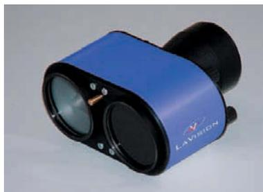
1台のカメラで同一面の画像をペアで記録するためのステレオスコープです。それぞれのイメージ用としてフィルターを別々にマウントすることができます。シングルショットでの LIF/Mie 同時測定や、二相の LIF にお使いいただけます。
