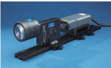
ParticleMaster Shadow システムで、パルスレーザに装着する光学系です。
