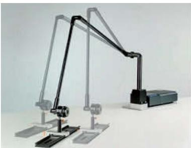
LaVision がサポートする Nd:YAG レーザに対応したビームデリバリー用の光学システムです。レーザー使用における安全性と、計測の柔軟性が向上します。
