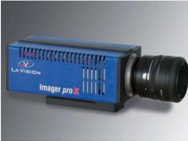
最大で11メガピクセルの解像度、ダイナミックレンジ14bitを有する、超高解像度・高感度のPIV用カメラです。カメラヘッドに最大4GBのメモリーを内蔵可能、ソフトウェアDaVisから完全コントロールできます。
