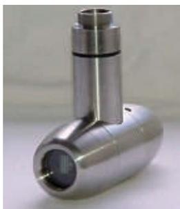
水没タイプのライトシート光学系です。流れ場への影響を抑える特別なデザインを採用。大型の水路や曳航水槽での船舶モデル周りの計測など、観測窓の設置が困難な対象においても PIV 計測を可能としました。
