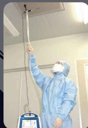
当社クリモマスター風速計用 プローブを使った環境計測風景
