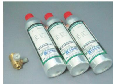
本体の校正には校正ガスキット (ゼロガス、COスパンガス、CO<sub>2</sub>スパンガス、レギュレーター) が必要です。測定精度維持のため、2~3カ月に1回程度のCO・CO<sub>2</sub>ユーザー校正をおすすめしています。
