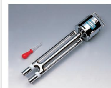
動力部に小型直流モーターを内蔵し、計測部には二重管温度計を付けた通風乾湿計です。湿度換算は換算表で行います。温度計は気象庁の検定付きです。
