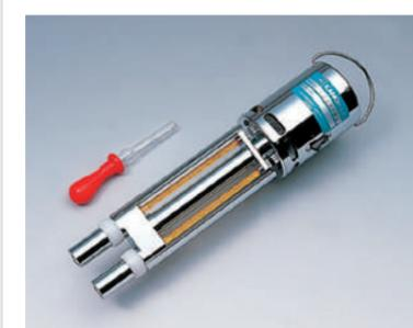
動力部に小型直流モーターを内蔵し、計測部にはガラス管温度計を付けた通風乾湿計です。湿度換算は換算表で行います。
