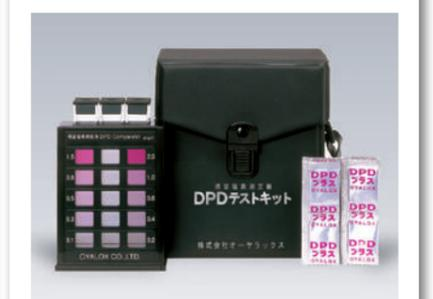
残留塩素を含有する水が濃度によってDPD試薬と作用して変色反応を起こし、その色と比色板の色とを比較する簡単な測定器です。コンパクトタイプで、水質管理を行う上でも最適です。
