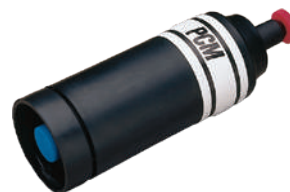
〔フィルターカセット〕 25 mmフィルターカセット アスベストなどの 繊維状物質のサンプリングに
