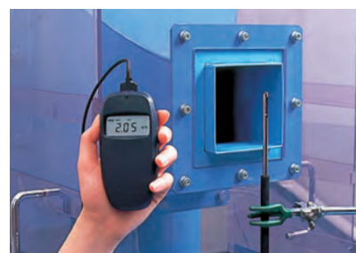
吹き出し口の風速測定に…
