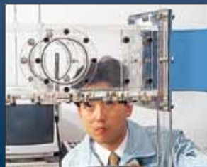
ダクト内の風速測定に
